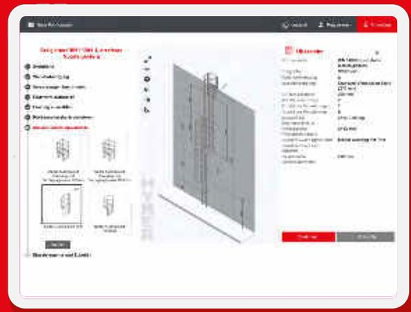
Bedienerfreundliche Konfiguration in wenigen Schritten: Steighöhe eingeben (passender Rückenschutz wird automatisch angezeigt), Plattform definieren, Einstiegsform wählen, Ausstiegsvariante festlegen und anschließend die Einzelelemente/das Zubehör aussuchen.
